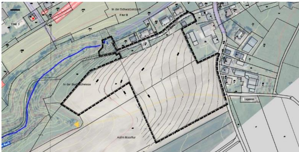
Abbildung 13: Auszug aus dem Lageplan zum Starkregenvorsorgekonzept (bearbeitet; Geltungsbereich und Höhenlinien der Vermessung ergänzt)
