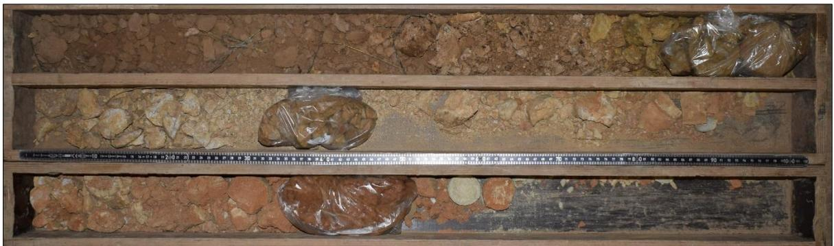
Foto 2: Erkundungsstelle 2 – Bohrgut Kleinrammbohrung
