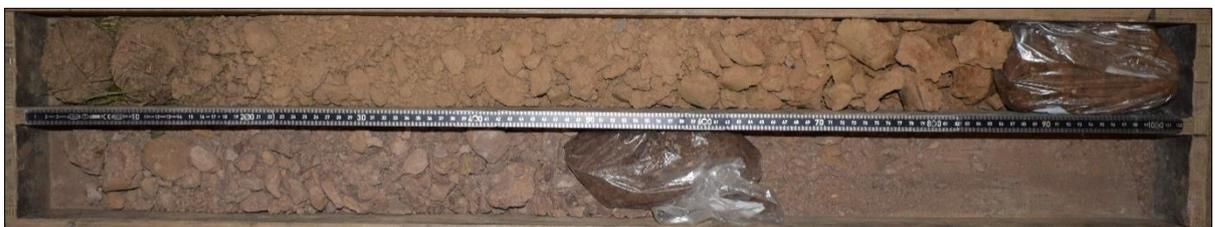
Foto 4: Erkundungsstelle 4 – Bohrgut Kleinrammbohrung
