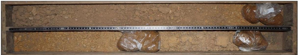
Foto 1: Erkundungsstelle 1 – Bohrgut Kleinrammbohrung
