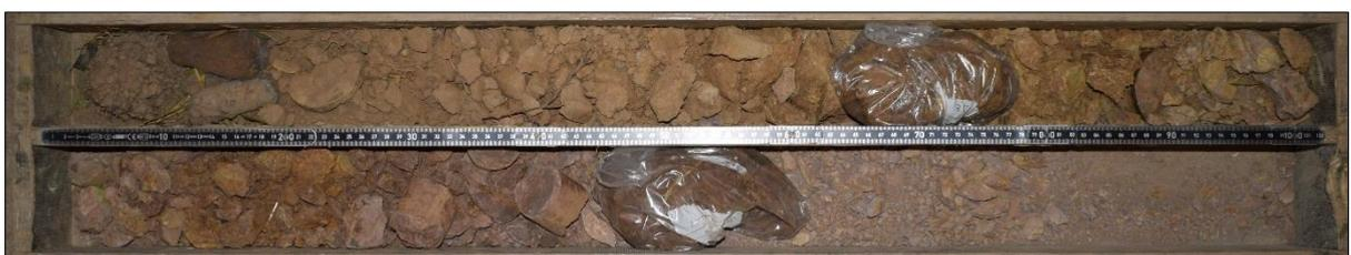
Foto 5: Erkundungsstelle 5 – Bohrgut Kleinrammbohrung
