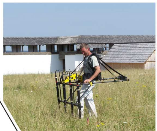
Vier-Kanal-Gradiometer FEREX bei der Messung
