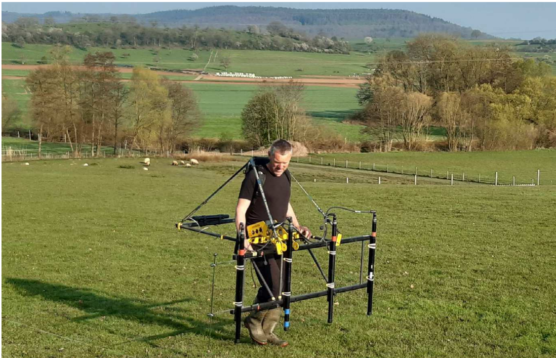
Bild 2, Fortsetzung: Oben: Blick auf die Messfläche von Osten aus, auf Höhe des Zauns, der die Schafweide im Norden unterteilt. Links im Bild die mehrere Meter mächtige Auffüllung, rechts im Hintergrund der Zaun, der die Schafweide / Messfläche nach Norden hin begrenzt. Unten: Messung mit dem Ferex Gradiometer
