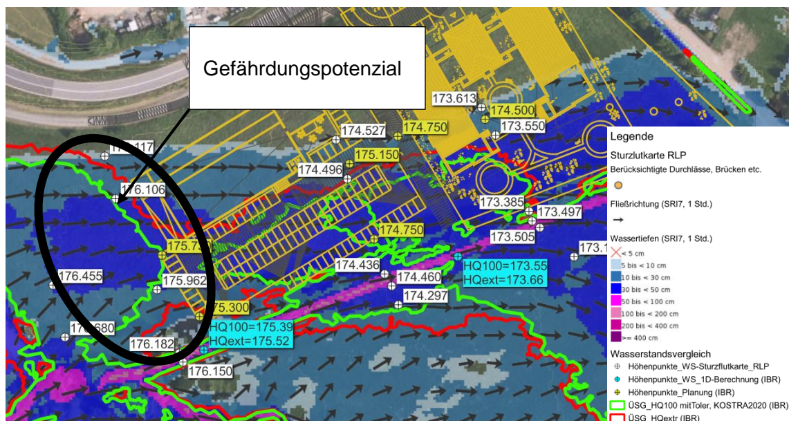
Abbildung 4: Überlagerung Sturzflutkarten, Wasserspiegellagenberechnung und Höhenplanung Neubau Lebensmittelmarkt
